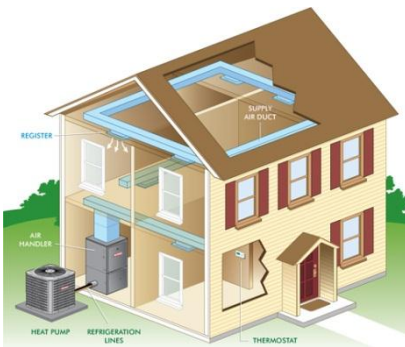
Bild 6: Wärmepumpensystem gespeist aus Umgebungsluft.
